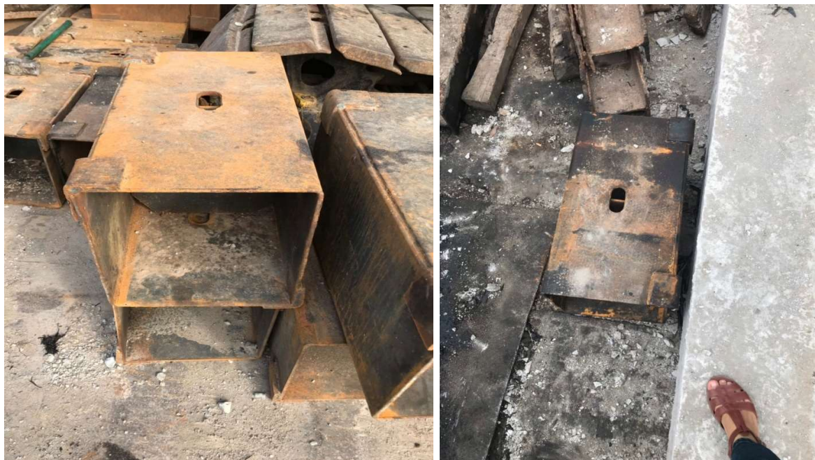
Hình 3-3 Hộp nối cọc BTCT
